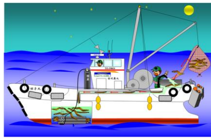
図4. 小型底びき網漁船に設置された噛み合いを防ぐための徳島発のソーメン流し
